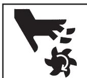
**¡CUIDADO!** Los cortadores anulares son filosos. Utilice guantes para instalar o sacar el cortador anular del árbol. No agarre un cortador anular en movimiento.
